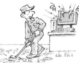
OAフロア用タイルのメンテナンス時には水・洗浄剤・剥離剤を大量に使用しないでください。床材の目地から水等が入り込み、床下の配線に悪影響を及ぼすことがあります。
